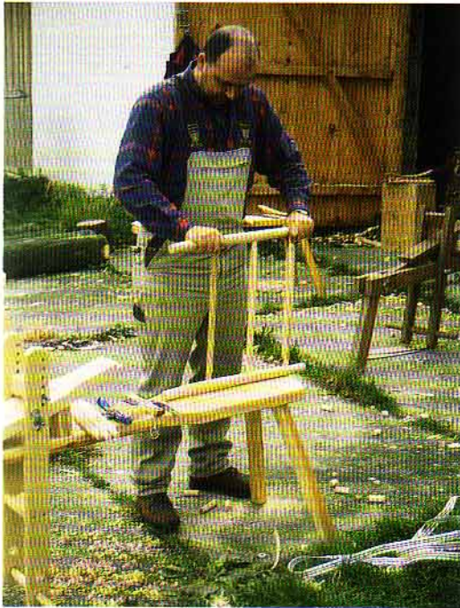
Das Bohren der Zapfenlöcher in den unregelmäßig geformten Beinen der Grünholzstühle erfordert genaues Anreissen und Arbeiten
