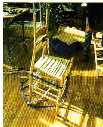
Die Sitzfläche der Grünholzstühle werden abschließend mit breiten Baumwollbändern geflochten, dadurch ergibt sich eine feste und dennoch elastische Sitzfläche.
