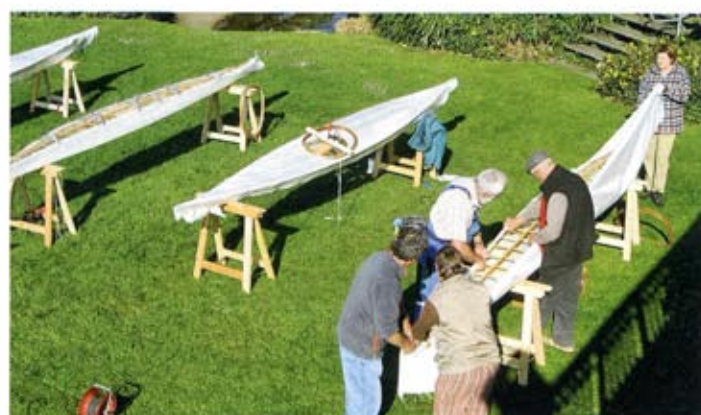
„Skin on Frame“ – eine Haut auf einem Tragrahmen, so lautet der englische Fachbegriff zur Konstruktion der Grönländerkajaks
