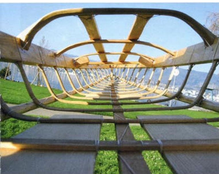
Filigrane Konstruktionsdetails und reduzierter Materialeinsatz geben dem Grönländerkajak eine vollkommen eigene Ästhetik
