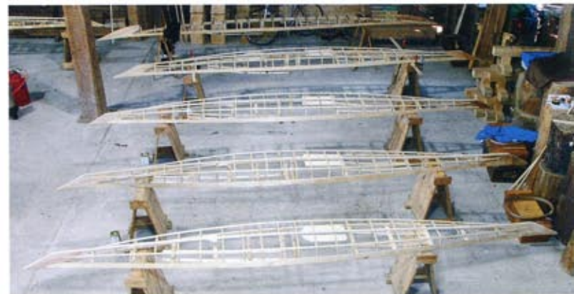
Stabile Ruhelage: Fertige Bootsröhlungen warten auf den Arbeitsgang des Besspannens mit einem speziellen textilen Gewebe
