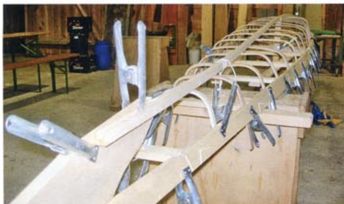
Zerlegbares Skelett: Der Bootsrumpf ist kopfüber aufgelegt und alle Spanten sind gebogen und provisorisch positioniert
