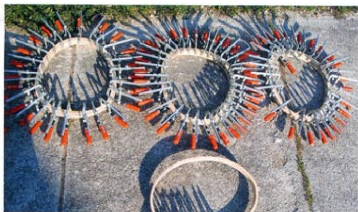
Unter Dampf gebogen: Ringe aus Eschenholz dienen zur Aussteifung der Einstiegsöffnung und zur Befestigung einer Spritzschutzdecke
