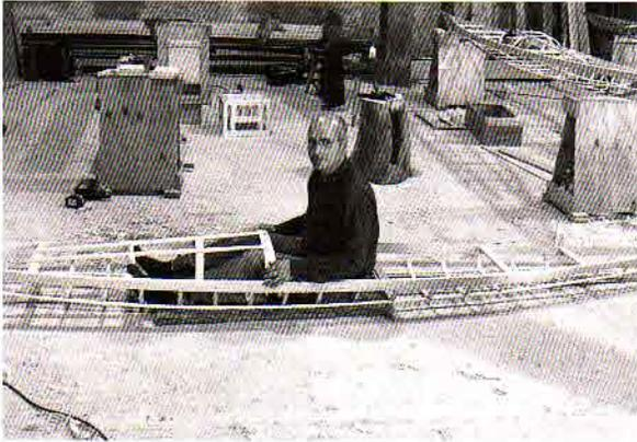
Wichtige Grundlage für den Bau ist die Ermittlung der Körpermasse und deren Übertragung in ein System, das die besten Eigenschaften garantiert. Mit Hilfe einer Wippe wird der individuelle Schwerpunkt, von dem aus alle weitere Masse übertragen werden, ermittelt. Dabei gibt es Spielraum für die Charakteristik des Bootes - ein Boot für den Paddelanfänger fällt anders aus als eines zum eskimotieren und sportlichen fahren.
